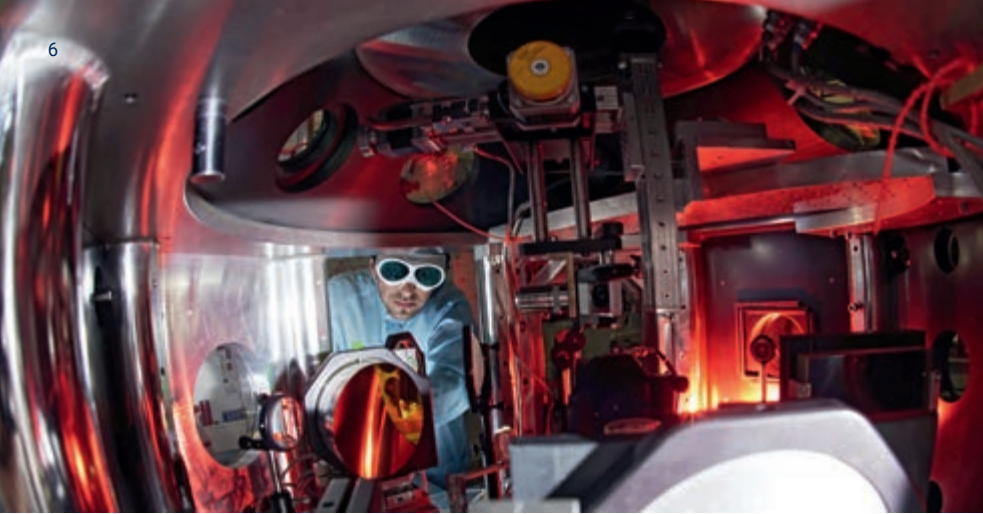
Forschungslabor zur nichtlinearen Optik: Targetkammer des »Jenaer Titan:Saphir 40 Terawatt Laser Systems«, kurz »JET140«.
