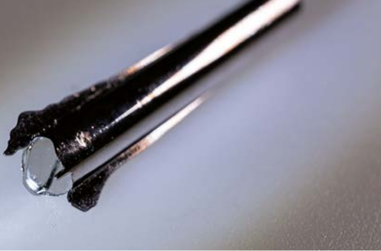
Metallisches Glas sieht von außen betrachtet aus wie gewöhnliches Metall. Im Inneren aber fehlt ihm die kristalline Gitterstruktur. Das macht es fest und spröde. · Foto: Jens Meyer
